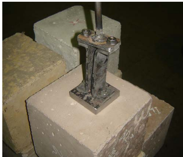
Figura B.2 Imagen de mecanismo utilizado para traccionar los tornillos.
