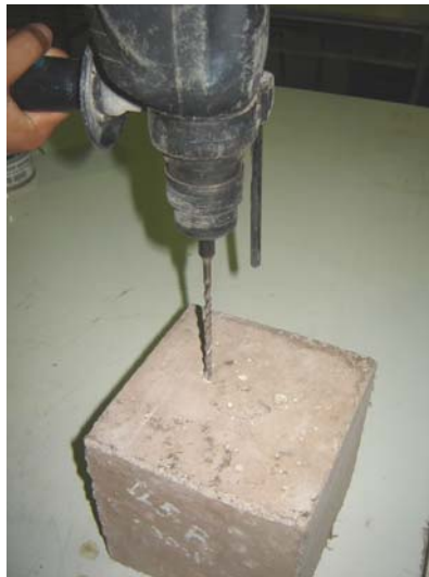
Figura B.1 Imagen de perforación realizada sobre el hormigón H-20.
