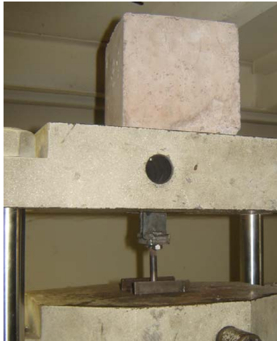
Figura B.3 Ensayo de tracción de los tornillos-tarugos.
