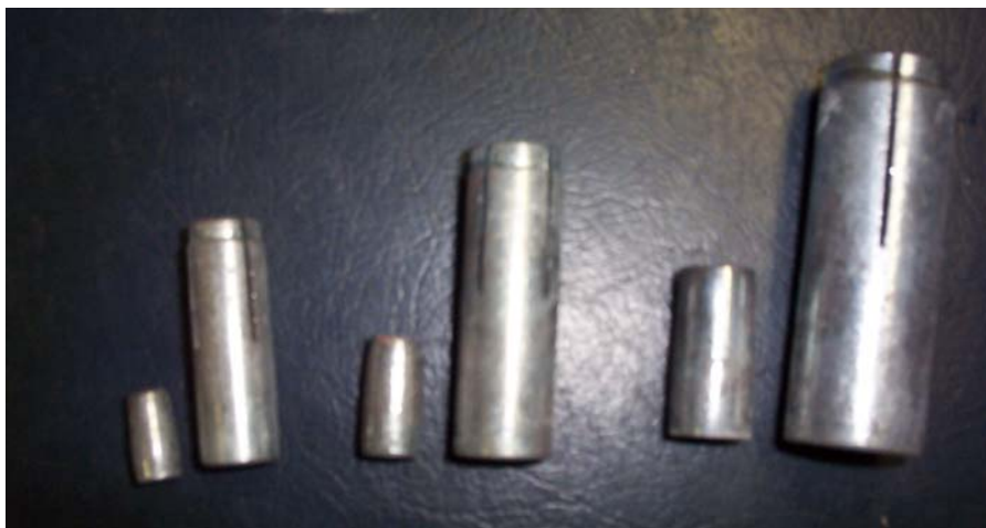
Figura E.1 Tacos después del ensayo de porosidad
