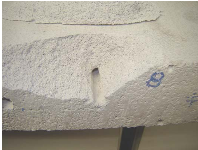
Figura B.4 Imagen de rotura de hormigón producto del ensayo de tracción.
