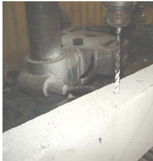
Figura B.1 Imagen de perforación realizada sobre el hormigón celular.
