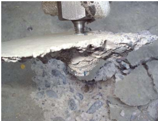
Figura B.5 fractura del hormigón donde se utilizaron los tacos de expansión
