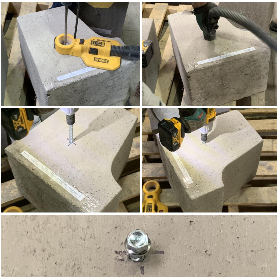
Figura B.1 Imagen del proceso de instalación de las muestras recibidas.
