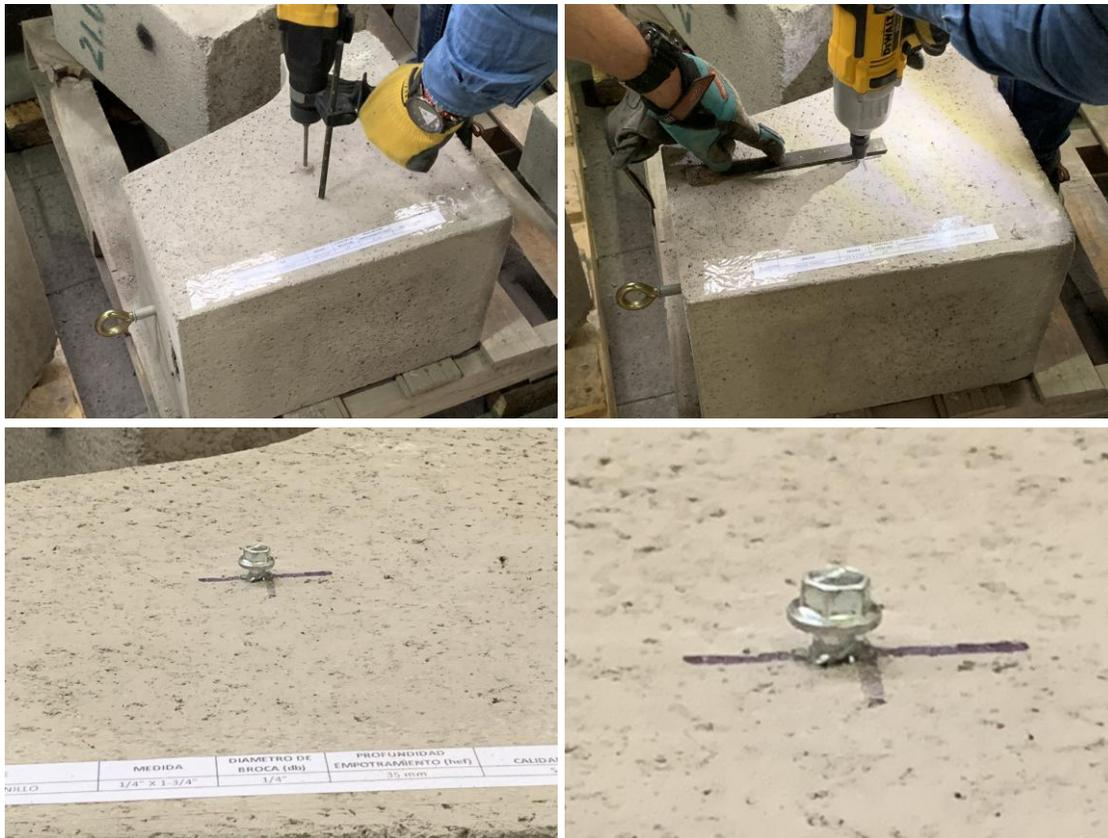
**Figura B.1** Imagen del proceso de instalación de las muestras recibidas.
