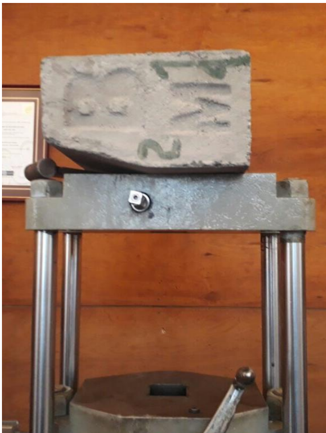
Figura B.2 Montaje para ensayo de tracción a cáncamos.
