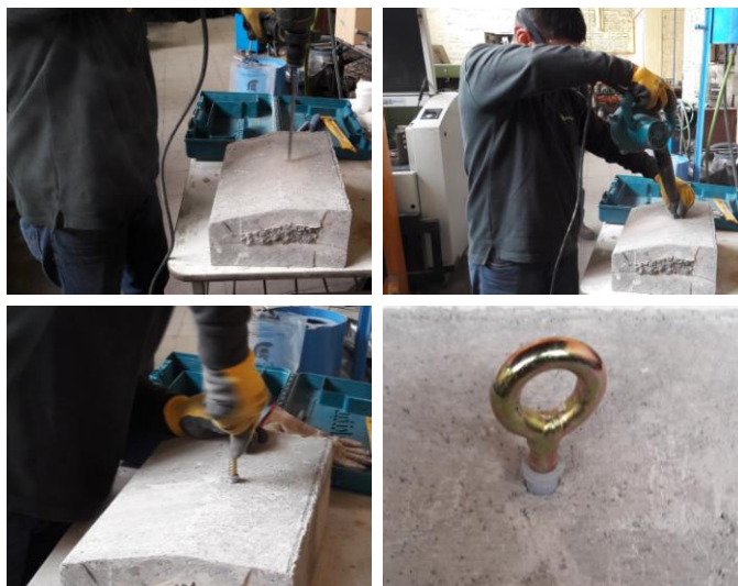
Figura B.1 Imagen de instalación de cáncamos en hormigón.
