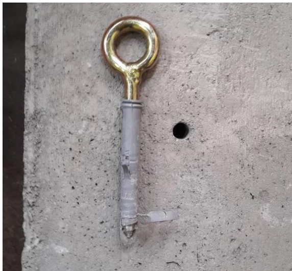
Figura B.3 Imagen de cáncamo después de realizado el ensayo.
