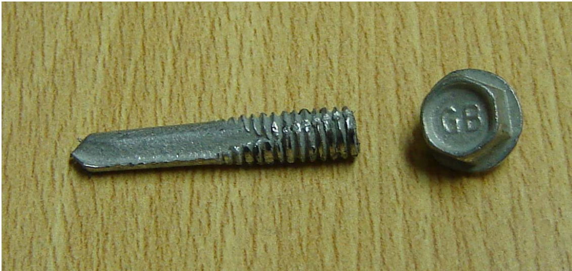
Figura E.1 Tornillo cortado después de la aplicación del corte.
