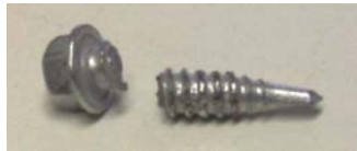
Figura F.1: Tornillo cortado después de la aplicación del corte.
